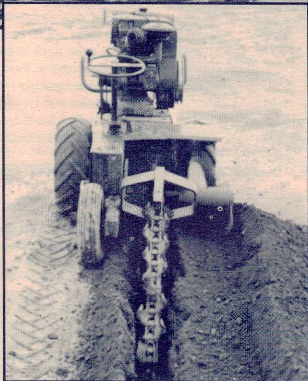
Arriba: Los surcos realizados por el tractor zanjeador. Abajo: El campo de juego a pocos días de su inauguración, desde la Tribuna Este.
